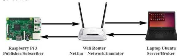
Figure 18. IoT system using MQTT và CoAP
